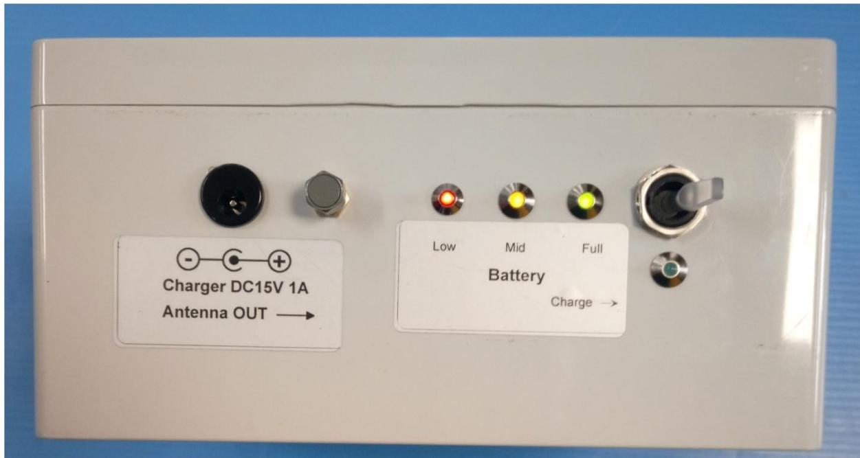
Le coffret de réémission GPS-GLONASS permet de diffuser de signal GPS & GLONASS dans un environnement pour lequel les signaux ne sont pas disponibles directement. L'utilisation en est très simple. Il suffit de connecter l'antenne active en vue des satellites de diffusion GPS sur le connecteur SMA, noté « Antenna Input » sur le côté gauche du coffret. Le câble coaxial de l'antenne active devra être de qualité et choisi au plus court, pour des performances optimales.
