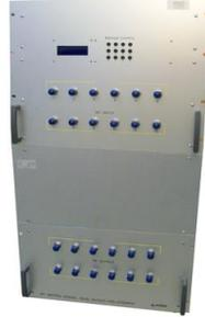
Les matrices d'atténuation sont conçues pour les tests automatiques, tels que le handover pour les applications GSM, DCS, UMTS, LTE, 5G ou WiFi. Elles sont contrôlées par un clavier et un écran LCD, et par Ethernet. Un logiciel permettant la programmation de scénarii est fourni.
