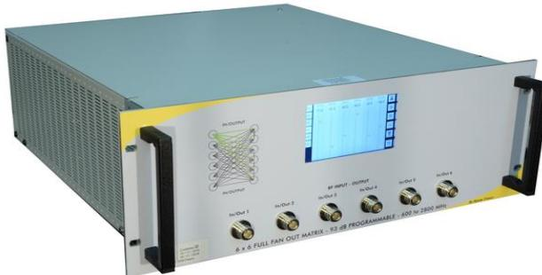
Les matrices d'atténuation sont conçues pour les tests automatiques, tels que le handover pour les applications GSM, DCS, UMTS, LTE, 5G ou WiFi. Elles sont contrôlées par un écran tactile, par USB ou par Ethernet. Aucune installation de logiciel n'est nécessaire grâce à un WebServer intégré.
