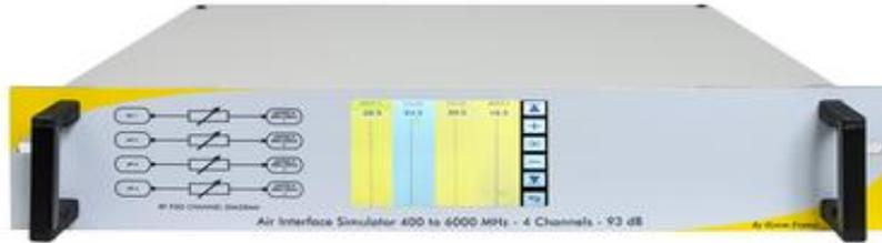
Les tiroirs d'atténuation sont conçues pour les tests automatiques, tels que le handover pour les applications GSM, DCS, UMTS, LTE ou WiFi. Ils sont contrôlés par un écran tactile, par USB ou par Ethernet.
